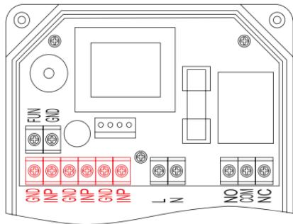
Клеммы для подключения датчиков протечки воды:
