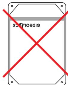
Разрешенное положение блока управления при монтаже.
